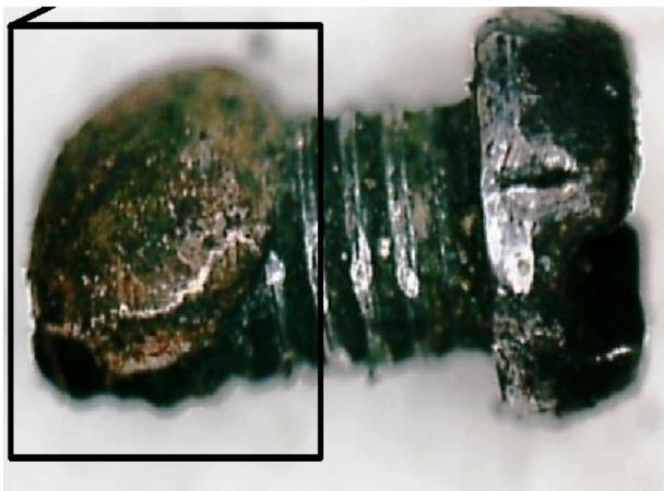
Рис. 5. Наплыв меди на поверхности винта винтового контактного соединения
