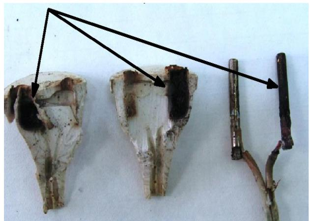
Рис. 6. Потемнение и оплавление на поверхности фрагментов штепсельной электровилки
