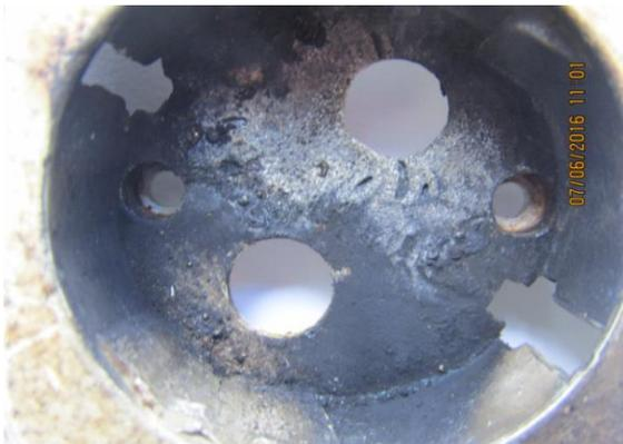
Рис. 3. Слой копоти на поверхности штепсельной электроколодки
