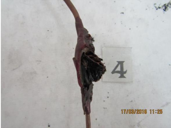
Рис. 1. Оплавление изоляционного материала на поверхности контактного соединения «в скрутку»
