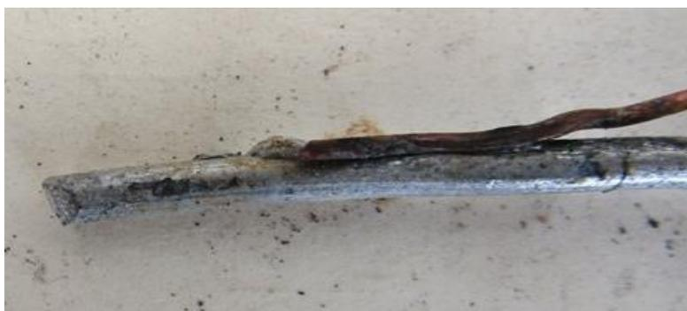
Рис. 7. Сплавление медного и алюминиевого проводников в винтовом контактном соединении
