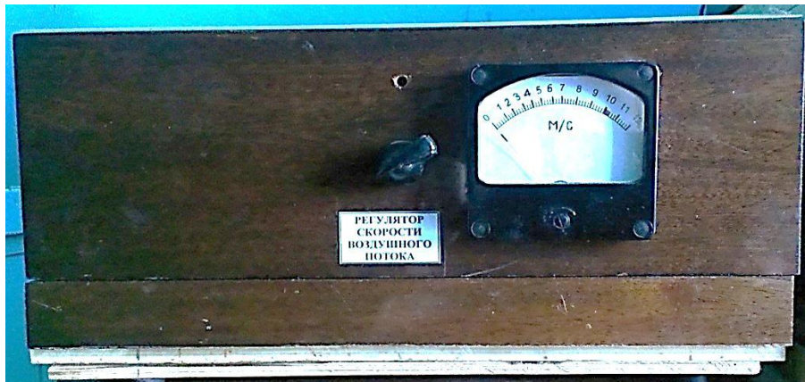
Рис. 4. Блок 3 – стабилизатор напряжения для нагнетательного вентилятора
