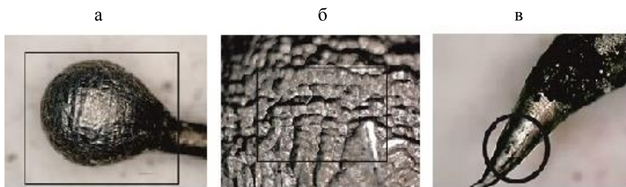
Рис. 2. Фрагменты поверхности оплавлений алюминиевого проводника при первичном коротком замыкании:
