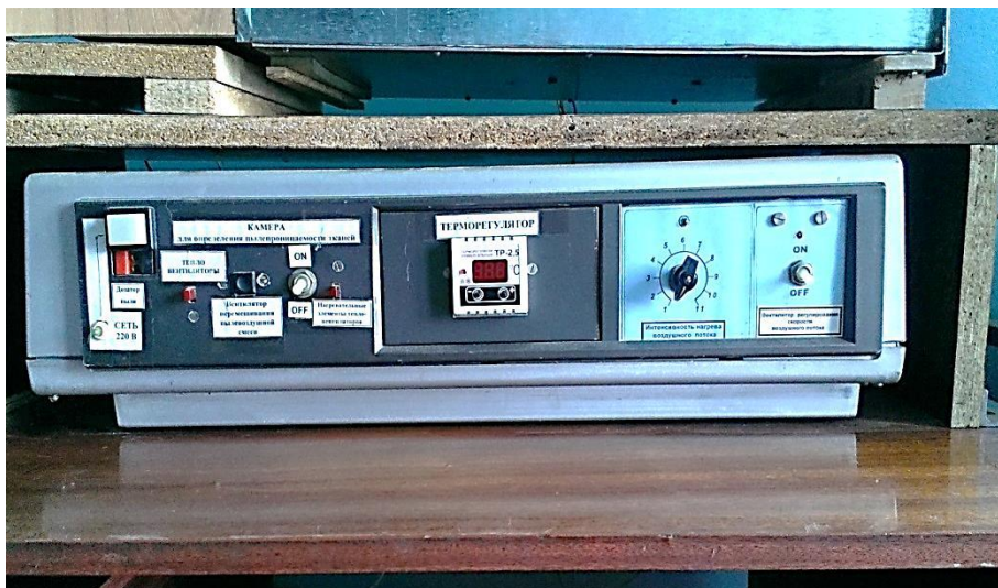
Рис. 5. Блок 4 – пульт управления камерой для определения пылепроницаемости
