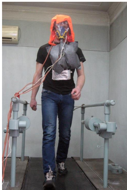
Рис. 2. Испытания самоспасателя СГЭ с участием испытателя-добровольца на беговой дорожке
