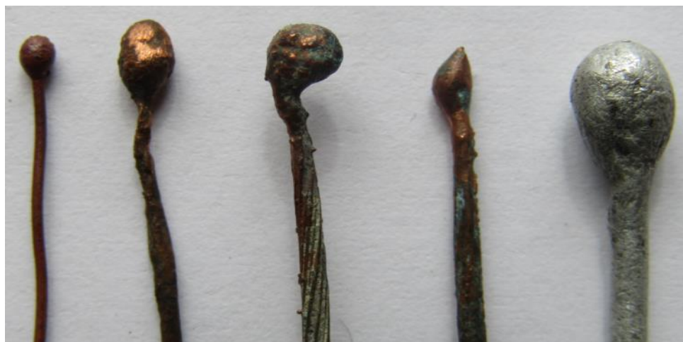
Рис. 3. Виды оплавлений проводников при первичном КЗ
