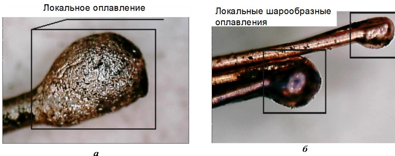
Рис. 2. Фрагмент оплавления проводника при первичном КЗ (увеличение в 20 раз):
