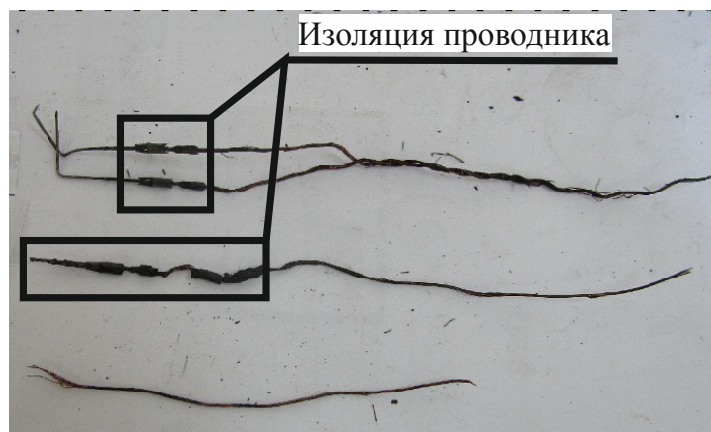
Рис. 1. Оплавления фрагментов проводников, образованные в результате внешнего воздействия высокой температуры при пожаре
