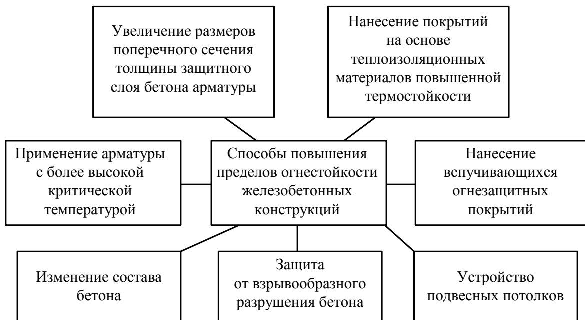
Рис. 1. Способы повышения пределов огнестойкости железобетонных конструкций
