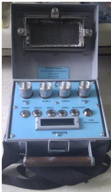
Рис. 4. Шахтный измеритель массопереноса метана ШИММ (ДС-03)
