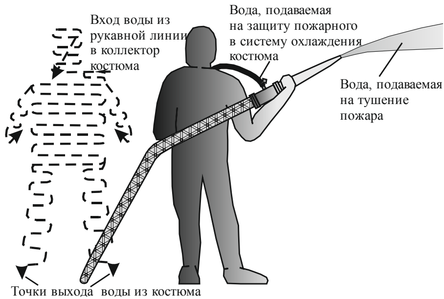
Рис. 1. Схема теплозащитного костюма с системой проточного водяного охлаждения
