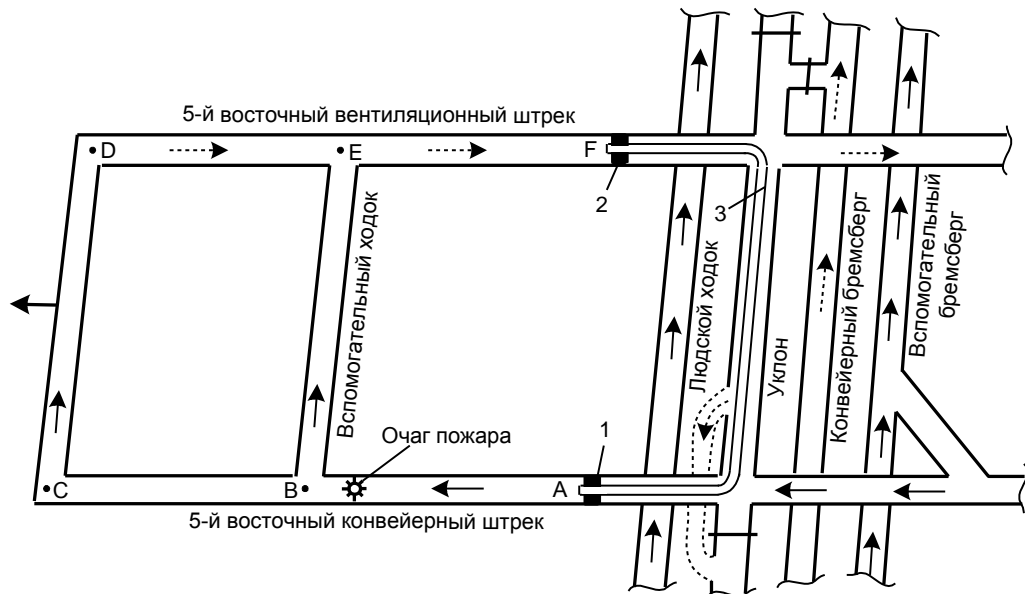
Рисунок 2. Изоляция участка при создании замкнутого контура с помощью трубопровода:
